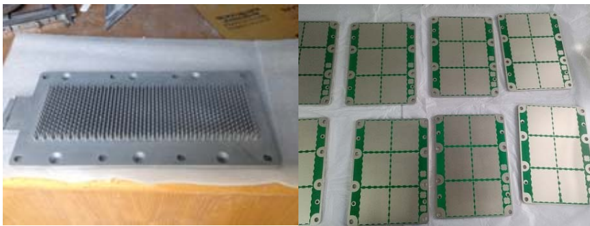
功率电子基板（上），电子基座（下：内含高导热石墨夹芯）
