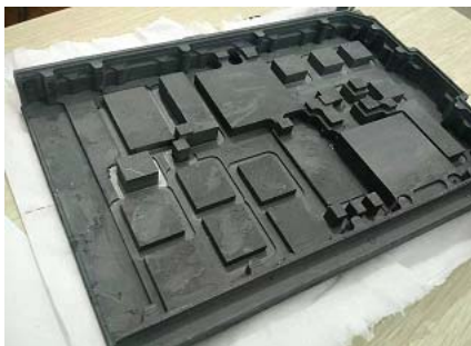
功率电子基板（上），电子基座（下：内含高导热石墨夹芯）
